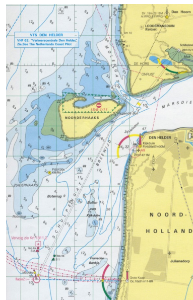
Het verlichtingssysteem voor begeleiding van de scheepvaart door het Schulpengat.
